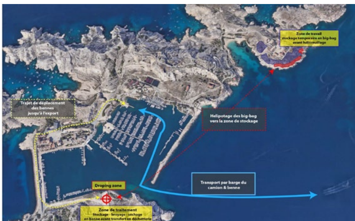
Schéma d'évacuation du chantier d'arrachage de l'hôpital Caroline © Agir Écologique
